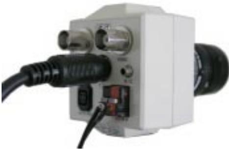
*Bild 7: Kameraanschluß S-Video und Spannungsversorgung*
